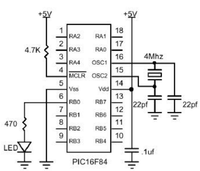
Construya y verifique este simple circuito en una tarjeta y enchufe el microPic que usted programó. Nuestra línea de tarjetas PICProto es perfecta para este tipo de cosas.
