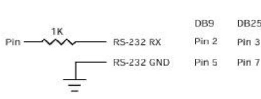
´ envía el valor ASCII de B0 ,seguido por un LF al pin 0 , en forma serial a 2400 baud
