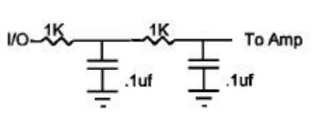
DTMFOUT trabaja mejor con un oscilador de 20 Mhz .También puede trabajar con uno de 10 Mhz y aún con uno de 4 Mhz , aunque será muy difícil de filtrar y tendrá muy baja amplitud .Cualquier otra frecuencia causará que DTMFOUT genere una frecuencia proporcional al oscilador comparado a 20 Mhz , lo que no será muy útil para enviar touch tones .
