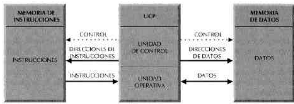
Figura 1.3. La arquitectura Harvard dispone de dos memorias independientes para datos y para instrucciones, permitiendo accesos simultáneos.
